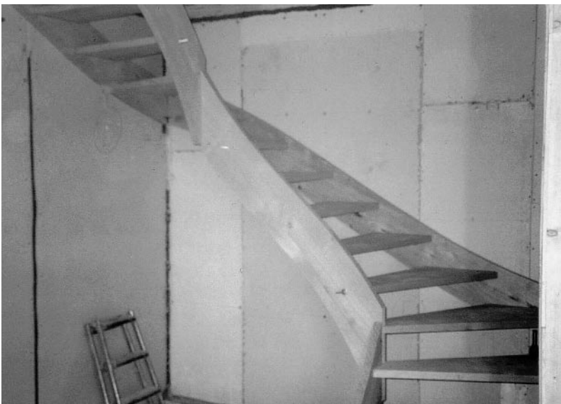
Bild 1: Massivholztreppe im Prüfstand
